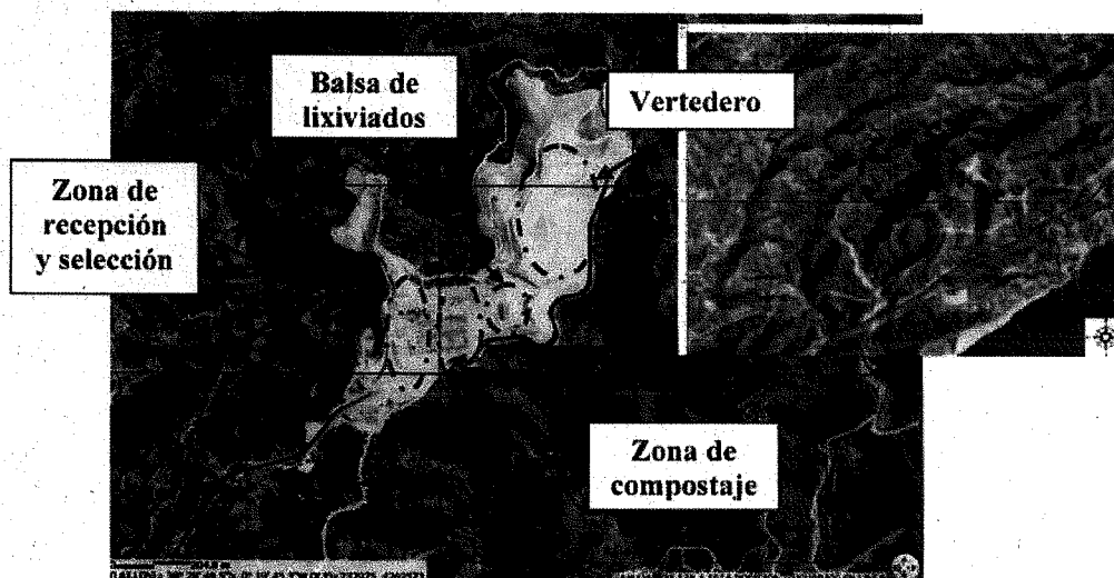
Representación de los focos emisores del centro de tratamiento de residuos en el software de modelización de la dispersión de los olores TROPOS IMPACT.
